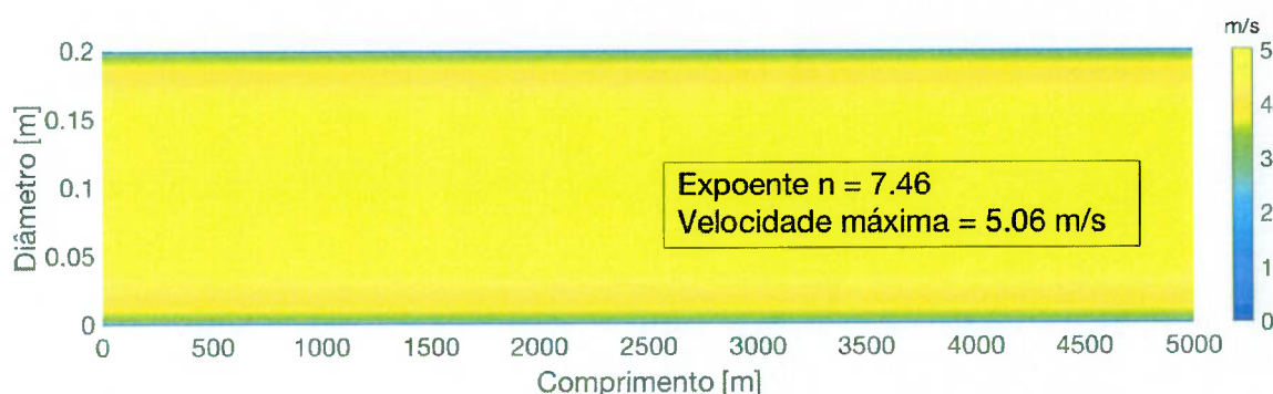
Figura 7: Perfil de velocidades do fluxo interno determinado pela equação da lei de potência com o valor calculado do expoente n
